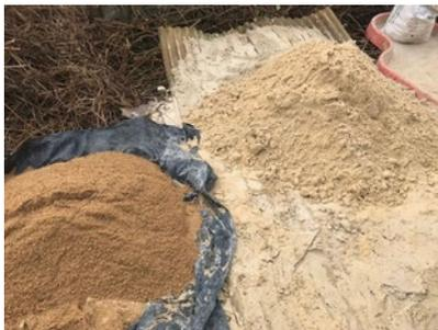
*Figure 16 Différence entre sable classique et sablon local. Tous les scellements ont été réalisés au mortier de chaux aérienne NHL3,5 et de sable local, type sablon de fontainebleau dont le granulométrie correspond à ce qui a été observé à la dépose.*
